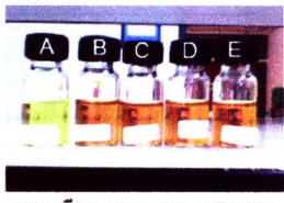
รูปที่ 3.4 ทดสอบสีของสารละลาย K_3Fe(CN)_6 mediator จากการเติมสารละลายตามตารางที่ 2.1 หลังตั้งทิ้งไว้ 30 นาที
