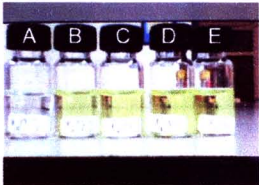
รูปที่ 3.3 ทดสอบสีของสารละลาย K_4Fe(CN)_6 mediator จากการเติมสารละลายตามตารางที่ 2.1 หลังตั้งทิ้งไว้ 30 นาที
