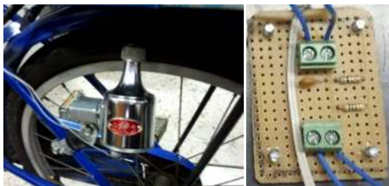
รูปที่ 4.4 ไดนาโมจักรยานและวงจรกรองแรงดัน
