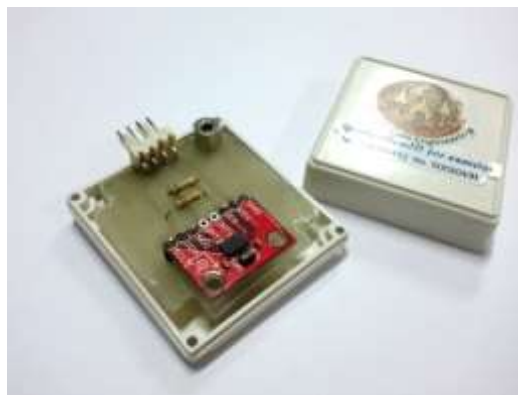
รูปที่ 4.2 ADXL345 พร้อมกล่องสำหรับติดตั้งบนศีรษะ
