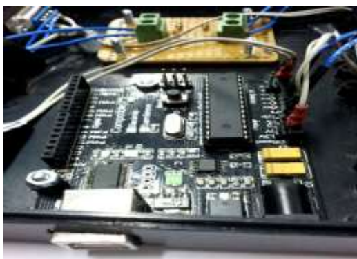
รูปที่ 4.3 บอร์ดไมโครคอนโทรลเลอร์ Arduino
