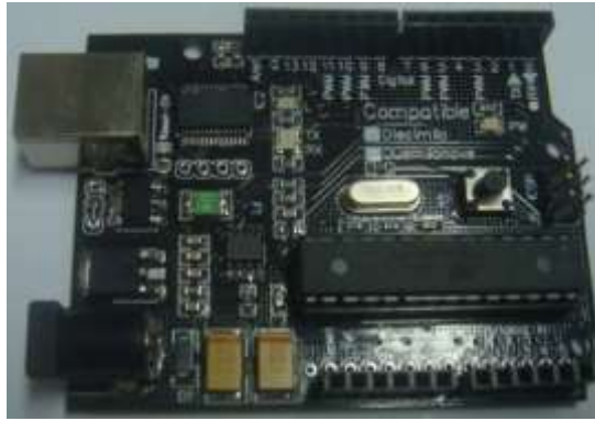
รูปที่ 2.1 ชุดโมดูลบอร์ดไมโครคอนโทรลเลอร์ Arduino
