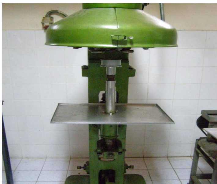
ภาพผนวกที่ 4 เครื่องปิดฝากระป๋อง ( Seamer )
