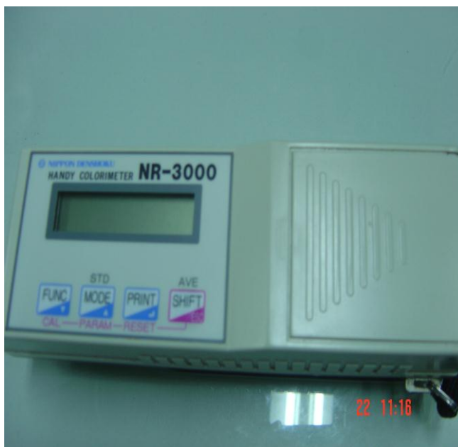
ภาพผนวกที่ 17 เครื่องวัดค่าสี ( Hunter color system )
