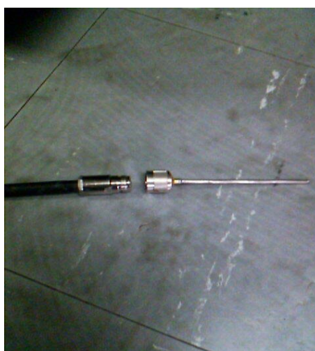
รูปที่ 5.25 ลักษณะการคับปลิงของสายอากาศกับโพรบ
