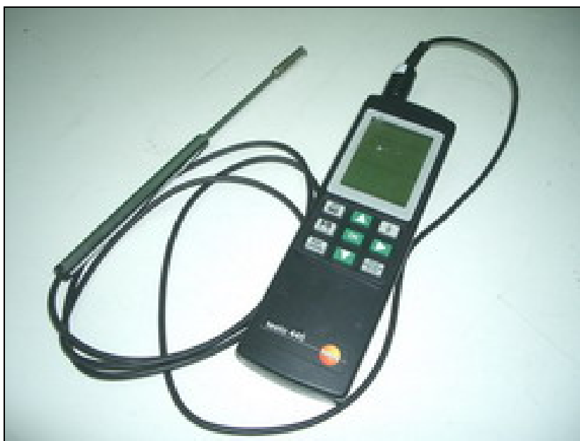
รูปที่ 4.7 แสดงอุปกรณ์วัดอัตราการไหลแบบ Hot wire – Testo445
