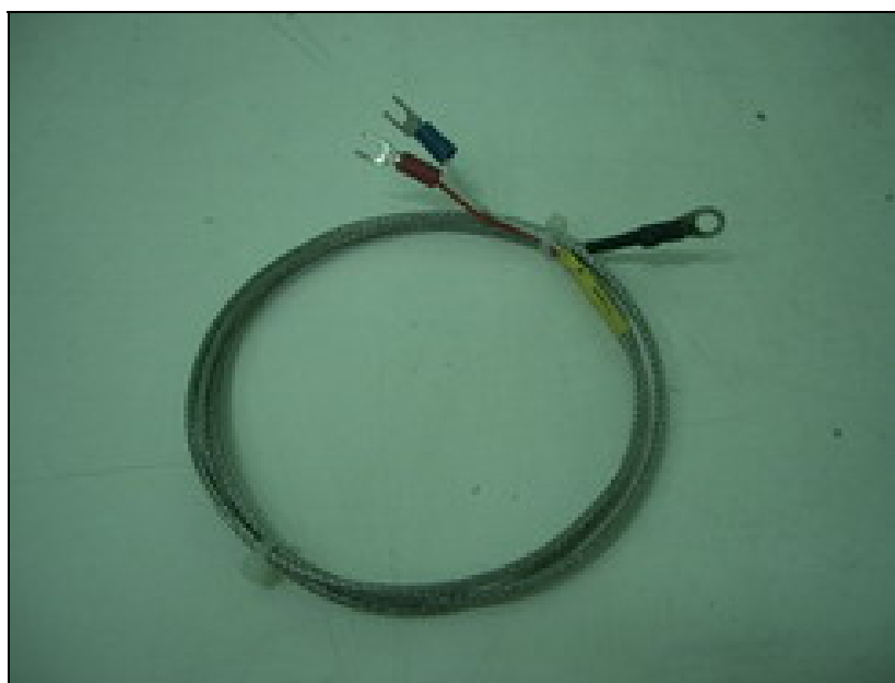
รูปที่ 4.10 แสดงส่วนประกอบของอุปกรณ์เทอร์โมคัปเปิล
