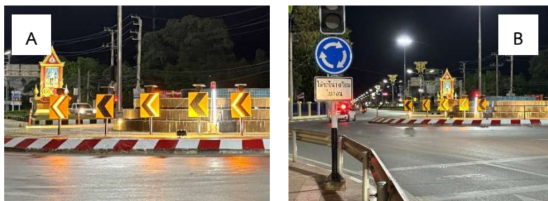
ภาพที่ 6 การปรับปรุงทัศนวิสัยในเวลากลางคืน: (A) ป้ายเตือนบริเวณขอบเกาะกลางวงเวียน (B) สัญญาณไฟวับวับบริเวณทางเข้าวงเวียน
