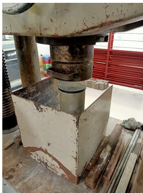
ข. การทดสอบกำลังอัดคอนกรีต
