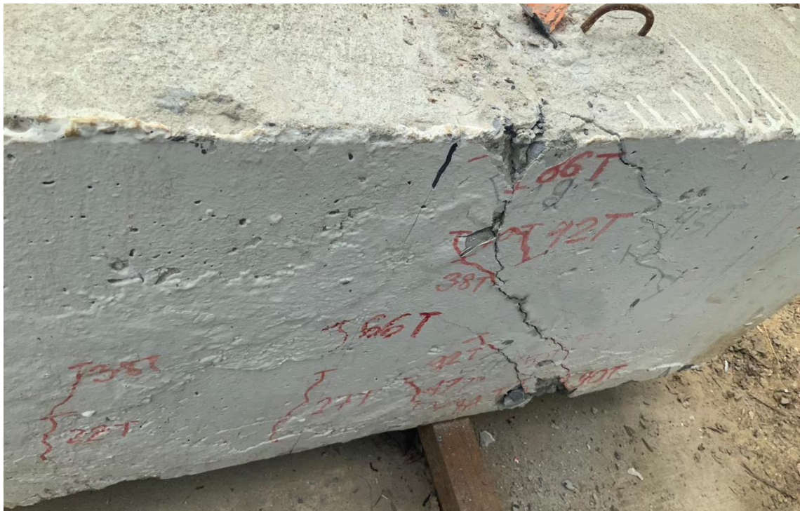
ภาพที่ 4.2 ลักษณะการวิบัติของคาน BR1
