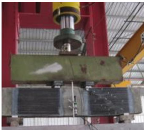
ภาพที่ 2.2.6 ลักษณะการเสริมแรง
