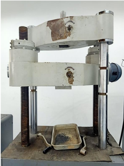
ค. ทดสอบกำลังดิ่งเหล็กเส้นกลม
