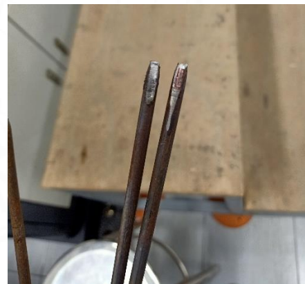
ฉ. การวิบัติของเหล็กเส้นกลม
