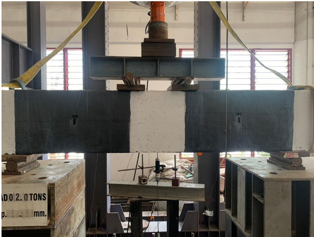
ภาพที่ 3.28 การติดตั้งคานทดสอบและอุปกรณ์ตรวจวัดคานที่เสริมกำลัง
