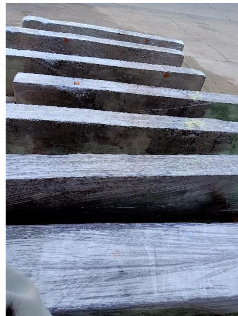
ภาพที่ 3.12 ถอดแบบหลังจากหล่อคานครบ 7 วัน และทำการบ่มคานตัวอย่าง 28 วัน
