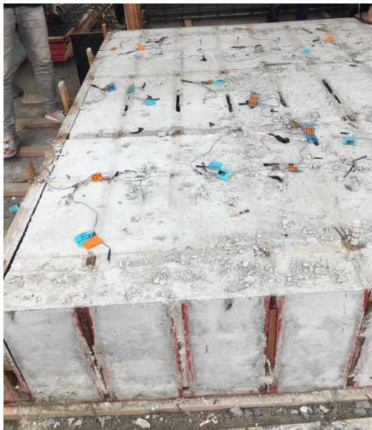
ภาพที่ 3.12 ถอดแบบหลังจากหล่อคานครบ 7 วัน และทำการบ่มคานตัวอย่าง 28 วัน
