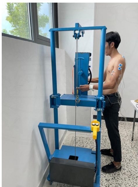
ภาพที่ 4.2 อุปกรณ์ยกแบบเคลื่อนที่ที่ออกแบบใหม่ในการศึกษาครั้งนี้
