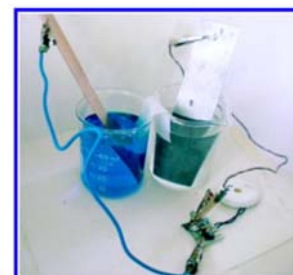
ภาพที่ 1 musical circuit board การสร้างเสียงดนตรีจากเซลล์กัลวานิก
