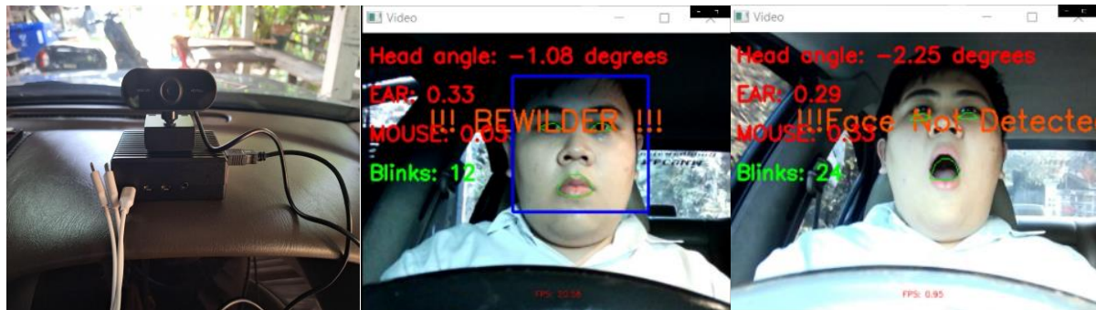
ภาพที่ 8 ติดตั้งกล่องเข้ากับคอนโซลหน้ารถ
