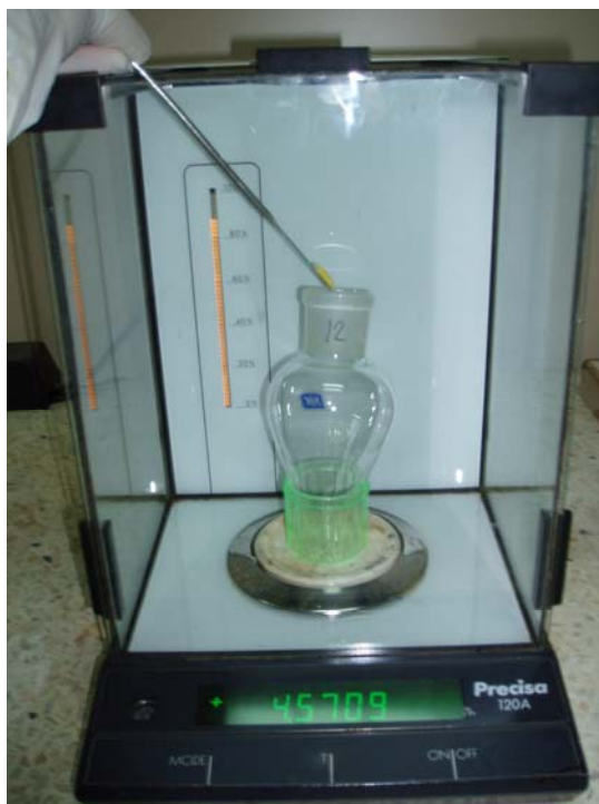
ภาพผนวกที่ ค13 การชั่งน้ำหนักตัวอย่างไขแดง เพื่อใช้ในการวิเคราะห์ปริมาณคอเลสเตอรอล
