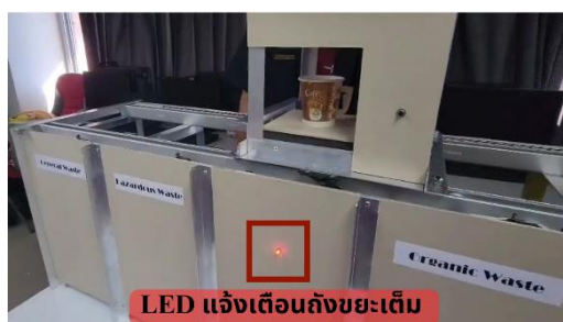
(ข) AI จำแนกแก้วกระดาษเป็นขยะ GW แต่ถังขยะ ประเภทนี้เต็มแล้ว ระบบจะหยุดทำงาน และไฟ LED จะแจ้งเตือนเพื่อให้ผู้ใช้ทำการนำขยะออก
