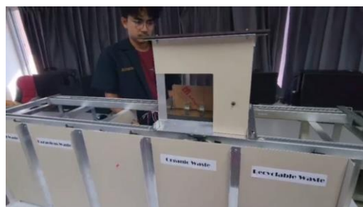
(ข) ระบบจะเลื่อนกล่องรับขยะไปยังถังขยะที่ถูกต้อง และทำการปล่อยขยะลงถังโดยอัตโนมัติ
