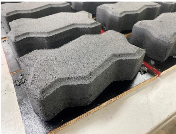
รูปที่ 1 บล็อกประสานปูพื้นจากการทดลองชุดที่ 1
