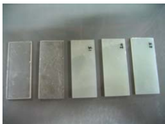
รูปที่ 4 ชิ้นงานที่ได้จากการขึ้นรูปที่สัดส่วนอนุภาคต่าง ๆ
