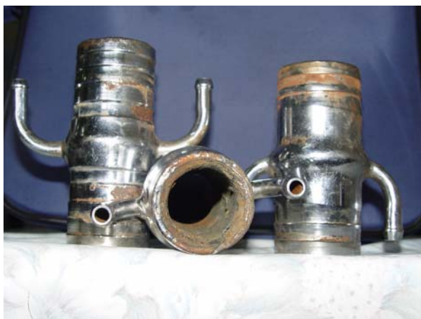
รูปที่ 3. อุปกรณ์เพื่อการประหยัดน้ำมันดีเซลก่อนการปรับปรุง (ใช้เหล็กในการผลิต)
