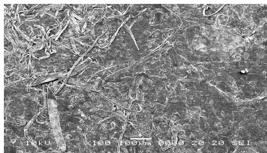
รูปที่ 3 ภาพถ่ายพื้นผิวพอลิเมอร์ผสมสูตรที่ 32 จากเครื่อง SEM ที่กำลังขยาย 100 เท่า
