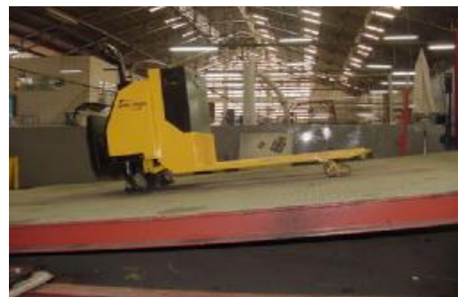
ภาพที่ 9 แสดงการทดสอบเสถียรภาพรถยกสูงรุ่น WSE 1030 น้ำหนักรถ 1015 กิโลกรัม
