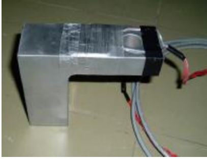
ภาพที่ 2 แสดงอุปกรณ์วัดแรง
