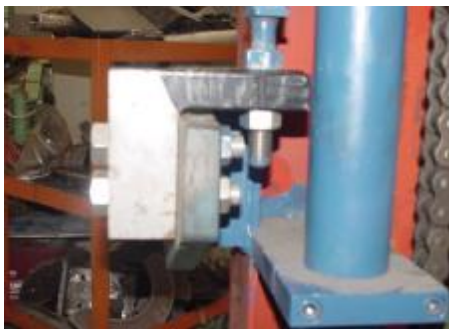
ภาพที่ 7 การติดตั้งอุปกรณ์วัดแรง
