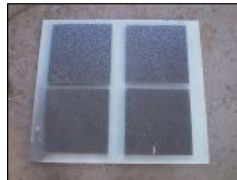
รูปที่ 6 อุปกรณ์กำบังรังสีแบบอื่น ๆ แผ่นตะกั่วเคลือบด้วยโพลีเอทิลีนสำหรับทำกำบังแบบใช้เงา
