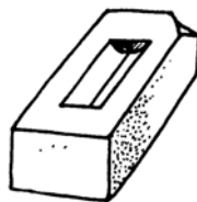
รูปที่ 2 อิฐที่มีมุมแตกหัก
