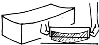
รูปที่ 3 อิฐแอ่นขึ้นจากการถอดแบบ
