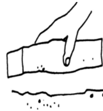
รูปที่ 5 อิฐที่วางบนพื้นขรุขระ
