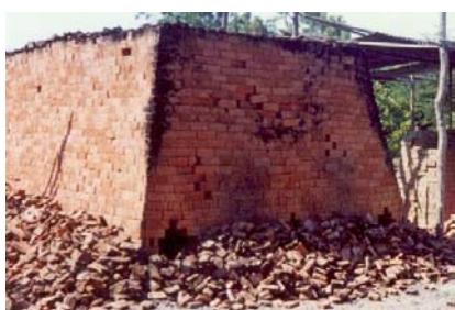
รูปที่ 10 ลักษณะการกองอิฐสำหรับการเผาด้วยฟืน
