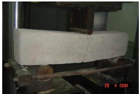
รูปที่ 12 แสดงลักษณะการเกิดรอยร้าวของคาน B1
