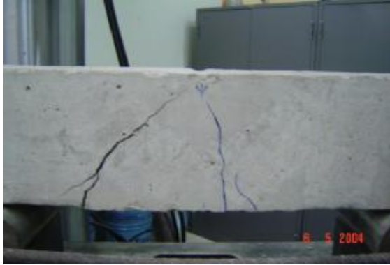
รูปที่ 14 แสดงลักษณะการเกิดรอยร้าวของคาน B2
