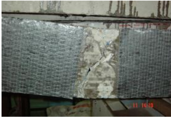
รูปที่ 8 แสดงลักษณะการเกิดรอยร้าวของคาน A4
