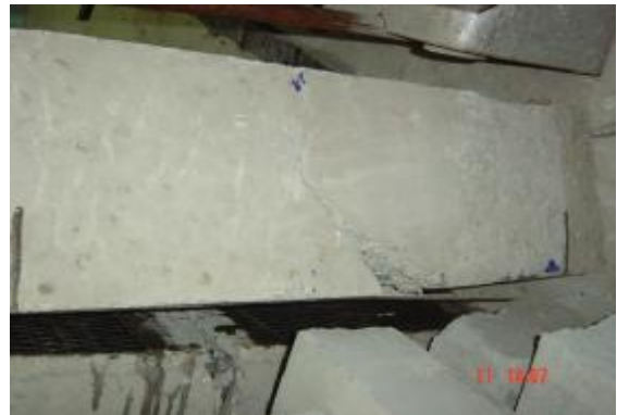
รูปที่ 6 แสดงลักษณะการเกิดรอยร้าวของคาน A3
