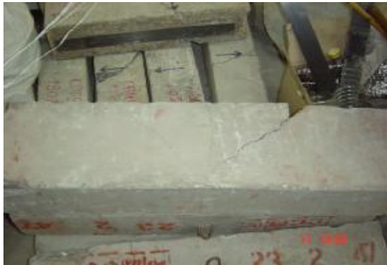
รูปที่ 2 แสดงลักษณะการเกิดรอยร้าวของคาน A1
