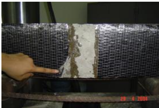
รูปที่ 16 แสดงลักษณะการเกิดรอยร้าวของคาน B3
