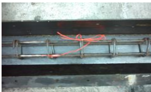
รูปที่ 2 Strain Gage ที่ติดตั้งที่เหล็กเสริม
