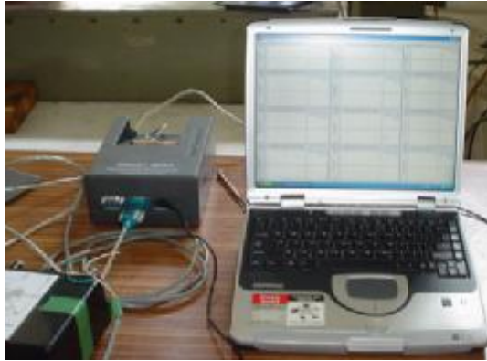
รูปที่ 5 การเก็บค่าความเครียด (Strain) จาก Strain Gage ผ่านเครื่อง Data Logger
