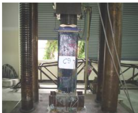
รูปที่ 4 การติดตั้งตัวอย่างเสาเข้ากับเครื่องทดสอบ
