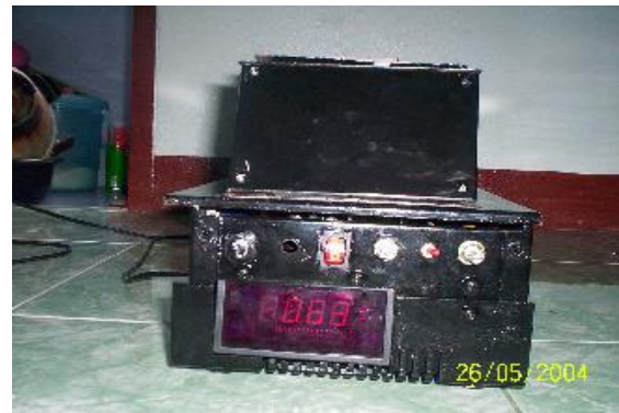
ภาพที่ 10 ภาพด้านหน้าของเครื่องควบคุมอุณหภูมิบ่อหลอมตะกั่ว
