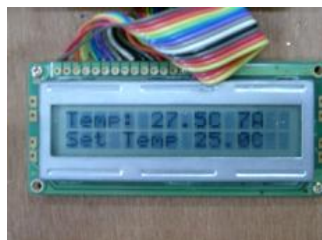
รูปที่ 17 การแสดงผลของวงจรถามอุณหภูมิ
