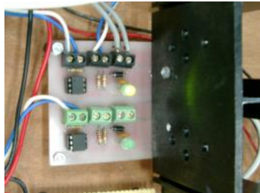
รูปที่ 15 ส่วนขับเคลื่อนสัญญาณ PWM ของวงจรถามการไหลของของเหลว
