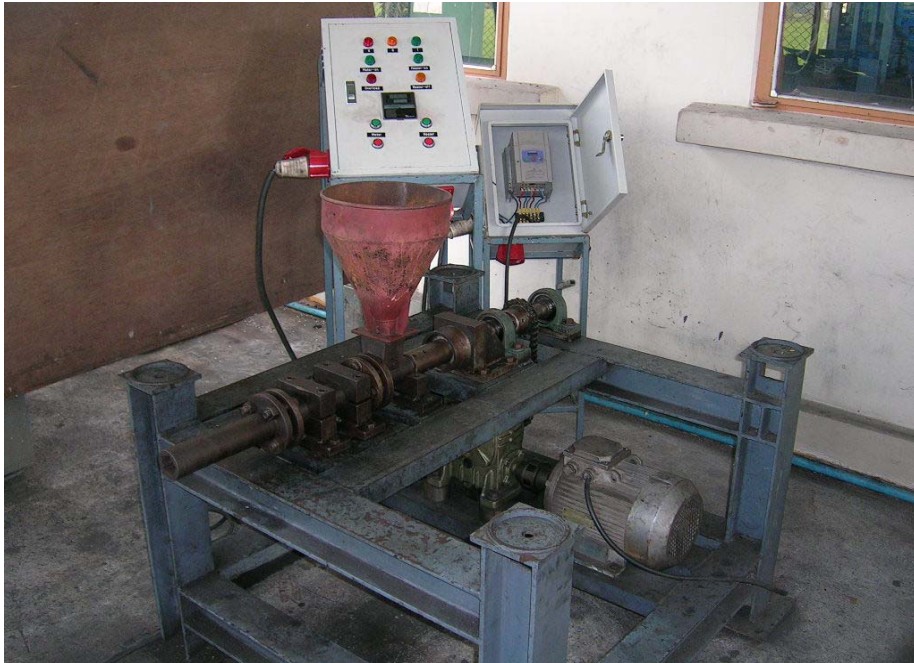
รูปที่ 6 แสดงเครื่องผลิตเชื้อเพลิงแท่งแข็งที่สร้างขึ้น
