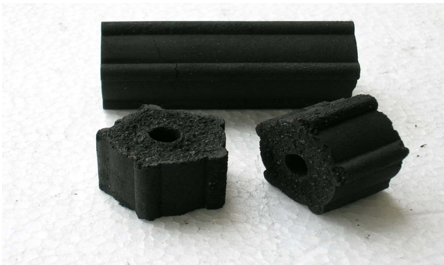
รูปที่ 7 แสดงแท่งเชื้อเพลิงที่อัดได้จากเครื่องผลิตเชื้อเพลิงแท่งแข็ง
