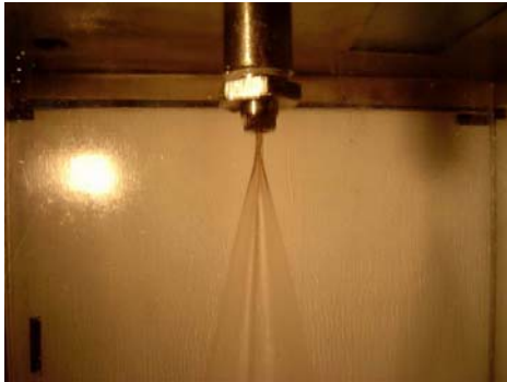
รูปที่ 4.1 แสดงการฉีดของหัวฉีด Full cone spray nozzle
