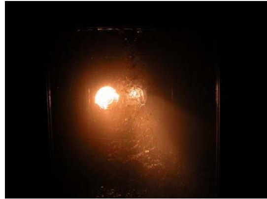
รูปที่ 4.4 แสดงการพ่นฝอยของหัวฉีด Air atomizing spray nozzle
