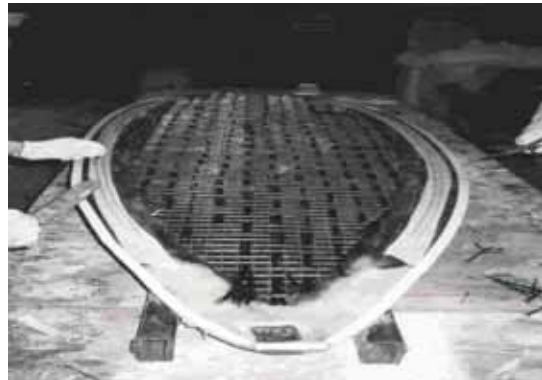
รูปที่ 2 แสดงลักษณะของการวางตะแกรงลวดที่มีเส้นใยคาร์บอนพันขัดอยู่
