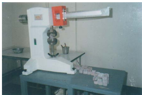
รูปที่3 การทดสอบกำลังรับแรงดึงของซีเมนต์มอร์ตาร์
