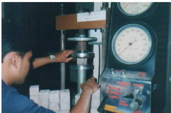
รูปที่2 การทดสอบกำลังรับแรงอัดของซีเมนต์มอร์ตาร์
