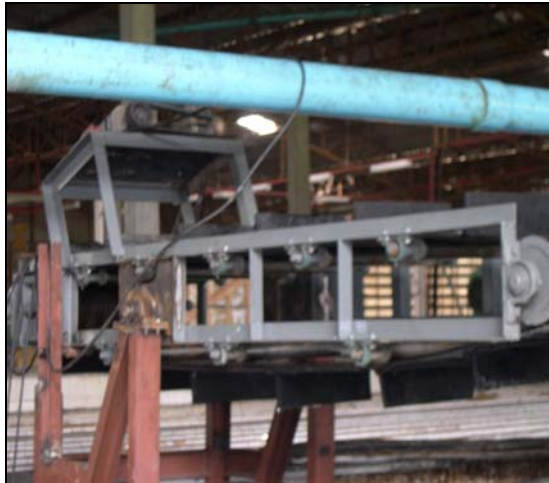
รูปที่ 4 แสดงลักษณะของเครื่องลำเลียงเมื่อปรับให้อยู่ในแนวระดับ เพื่อต้องการเคลื่อนเครื่องลำเลียงไปยังบ่อทวนอื่นๆ
