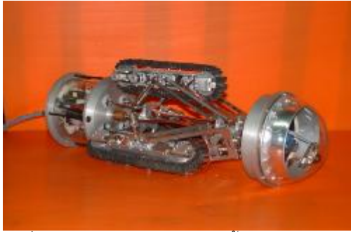
รูปที่ 1 หุ่นยนต์สำรวจท่อระบายน้ำเสีย
