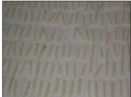
รูปที่ 9 ขนมบนสายพานเมื่อเครื่องสั่นมาก
