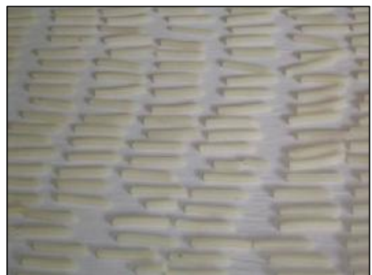
รูปที่ 10 ขนมบนสายพานเมื่อเครื่องสั่นน้อย
