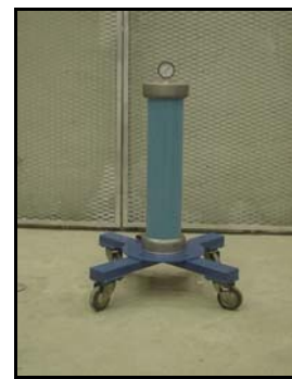
รูปที่ 7 โวลเตจดีไวเดอร์ขนาดพิกัด 100 kV
