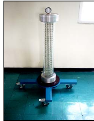
รูปที่ 12 โวลเตจดีไวเดอร์ขนาดพิกัด 150 kV.
