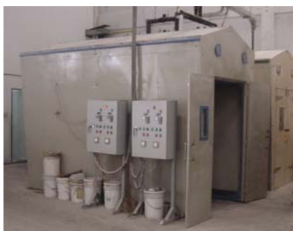
รูปที่ 1.2 ตู้อบแห้งขนม (Dryer)
