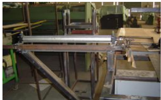
รูปที่ 4 แบบแสดงส่วนใบมีดปรับระยะความสูงแผ่นสับในแนวราบ
