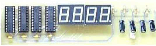
รูปที่ 4 การแสดงผลของวงจรแสดงผลผ่านทาง 7- SEGMENT
