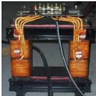
รูปที่ 3 หม้อแปลงไฟฟ้ากระแสสูง
