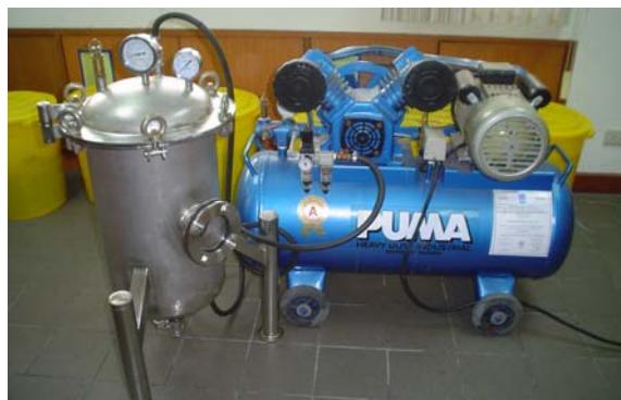
ภาพที่ 4 การทำงานของถังหมักความดัน
