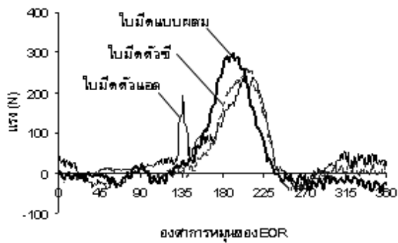
รูปที่ 8 กราฟแสดงแรงต้านทานแนวระดับที่กระทำบน ใบมีดชนิดตัวแอล ชนิดตัวชี้ และแบบผสม ในการทดลองพรวนที่ระยะตัด 9 เซนติเมตร
