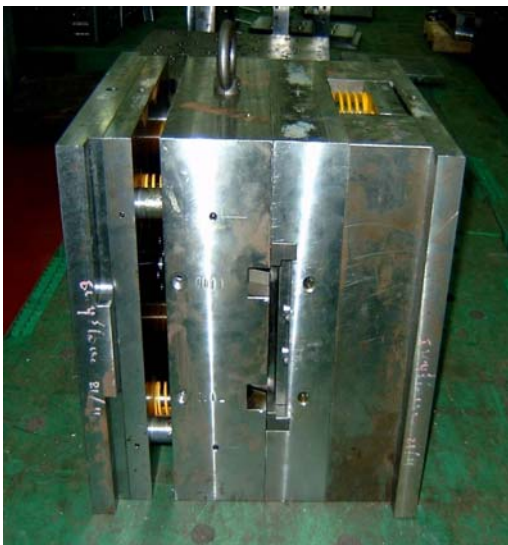
รูปที่ 3 แม่พิมพ์ฉีดใบพัดลมเครื่องปรับอากาศ
