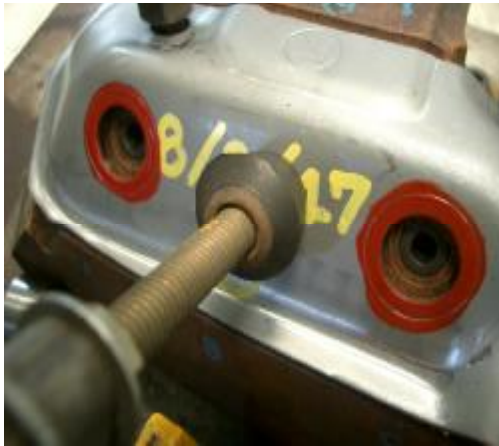
รูปที่ 7 รูปงานแสดงตำแหน่งการวัดขนาดเส้นผ่านศูนย์กลางของรู
