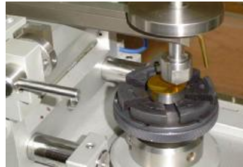
รูปที่ 2 ภาพแสดงการทดสอบด้วยเครื่องไตรโบมิเตอร์
