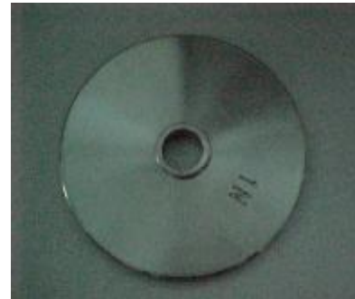
รูปที่ 2 ภาพแสดงตัวอย่างลักษณะของลูกตุ้มมาตรฐานขนาด 1 N
