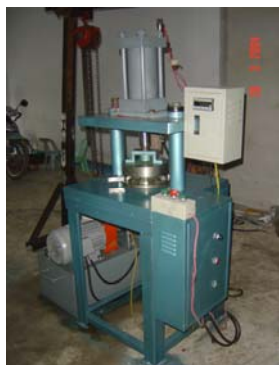
รูปที่ 1 เครื่องทดสอบความแข็งแรงของรอยเชื่อมของ ลวดเหล็ก
