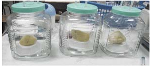
รูปที่ 2 ระบบเก็บก๊าซแบบปิดที่ดัดแปลงมาใช้ในโครงการ เพื่อวัดอัตราการหายใจของเนื้อทุเรียนหมอนทอง
