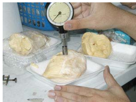
ภาพที่ 3 การวัดความแน่นเนื้อทุเรียนด้วย firmness tester
