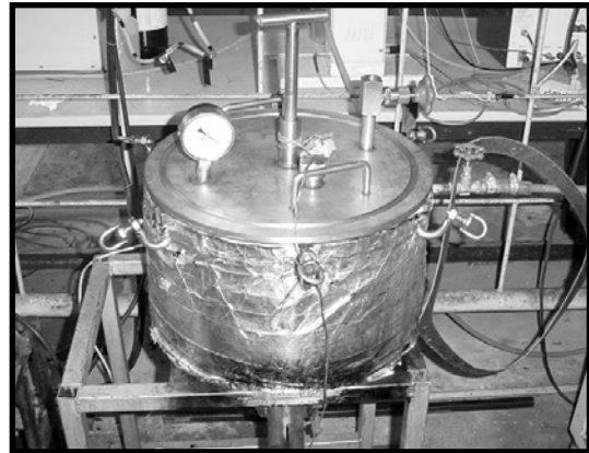
รูปที่ 2 vacuum fryer ที่ใช้ในโรงงาน (ราม แยมแสงสังข์, 2003)
