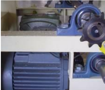
รูปที่ 5 ชุดมอเตอร์ที่ใช้ในการตัดแผ่นก๊วย
