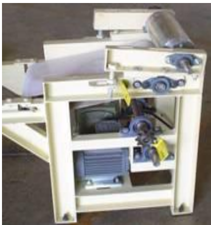
รูปที่ 6 ชุดโครงฐานรองรับของเครื่องตัดแผ่น
