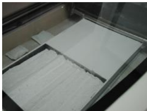
รูปที่ 27 ภาพปริมาณแป้งที่เติมลงไปก่อนที่เครื่องจะสั่งปรับผิวหน้าแป้ง
