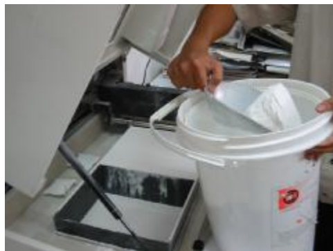
รูปที่ 26 ภาพการเติมแป้งเพื่อให้ปริมาณเหมาะสมกับการทำงานของเครื่อง
