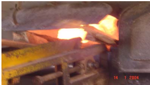
รูปที่ 3.2 แสดงปัญหาการกองทับถมกันตรงปากเตา ขณะป้อนปึกไม้ยางพาราเข้าสู่เตาเผา
