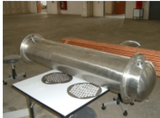
รูปที่ 3. แสดงลักษณะของเครื่องแลกเปลี่ยนความร้อนที่สร้าง
