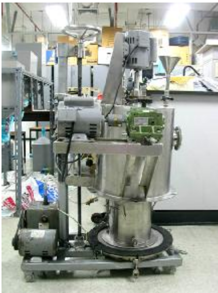
รูปที่ 10-4 เครื่องต้นแบบของเครื่องผสมแบบ สุญญากาศ
