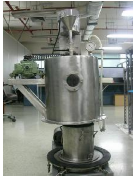
รูปที่ 10-5 เครื่องต้นแบบของเครื่องผสมแบบ สุญญากาศ
